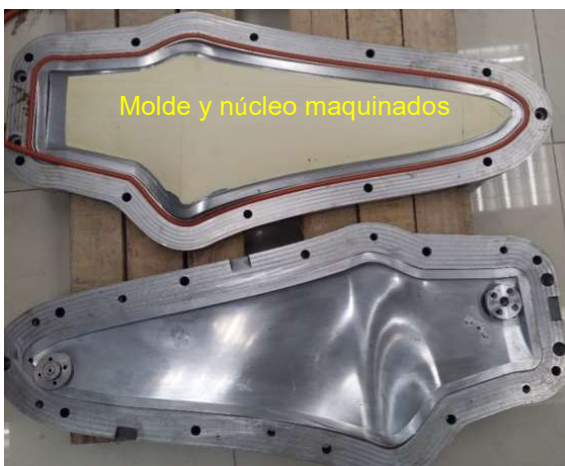
Figura 3. Molde calefactado para manufactura del álabes por RTM.
